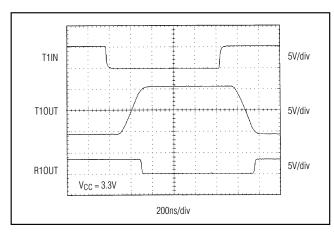
Figure 10. MAX3225/MAX3227/MAX3245 Loopback Test Result at 1Mbps
