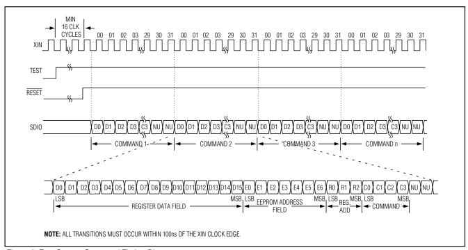
Figure 3. Test-System Command Timing Diagram
