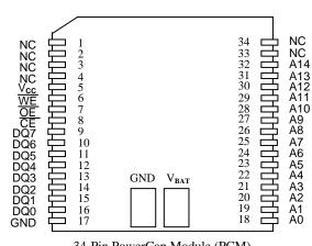
34-Pin PowerCap Module (PCM) (Uses DS9034PC PowerCap)
