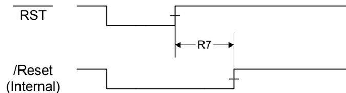
Figure 19-10. Power-On Reset Timing
