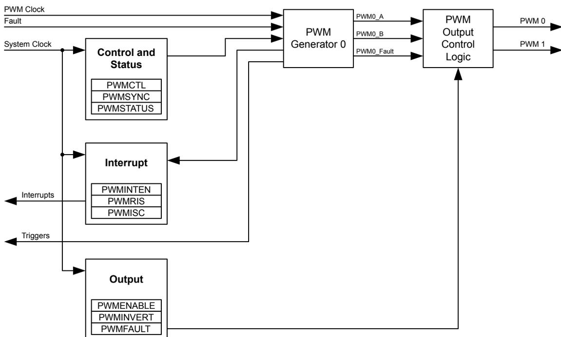
Figure 16-2. PWM Module Block Diagram
