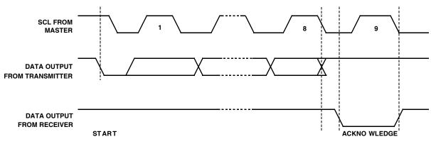
FIGURE 2. ACKNOWLEDGE RESPONSE FROM RECEIVER
