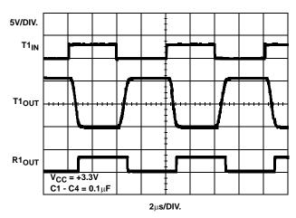
FIGURE 14. LOOPBACK TEST AT 250kbps
