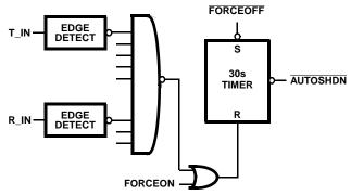
FIGURE 7. ENHANCED AUTOMATIC POWERDOWN LOGIC
