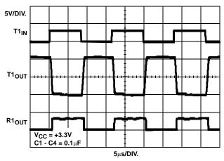
FIGURE 13. LOOPBACK TEST AT 120kbps
