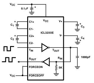
FIGURE 12. TRANSMITTER LOOPBACK TEST CIRCUIT
