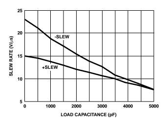
FIGURE 16. SLEW RATE vs LOAD CAPACITANCE
