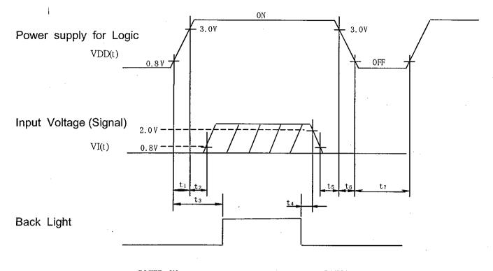
$\begin{array}{ccc} \underline{\text{POWER ON}} & & & \\ & & t_1 \leq & 15\,\text{ms} \\ & 0\,\text{ms} < t_2 \leq & 45\,\text{ms} \\ & 0.\ 1s \leq & t_3 \end{array}$
