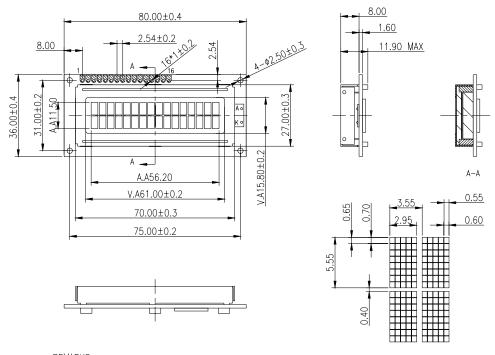
REMARKS: 1,UNMARKED TOLERANCE IS ±0.4, 2,THE MATERIALS COMPLY WITH ROHS.
