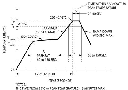
$T_{smax} = 200^{\circ}C$ ,  $T_{smin} = 150^{\circ}C$
