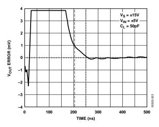
Figure 22. Settling Time, Positive Edge
