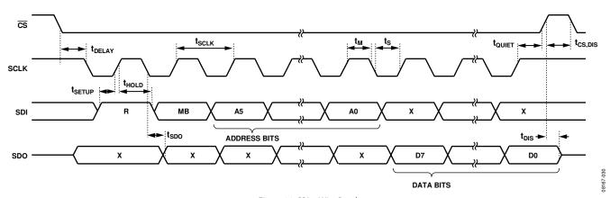
Figure 30. SPI 4-Wire Read
