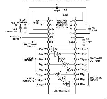
1INTERNAL 400kΩ PULL-UP RESISTOR ON EACH CMOS INPUT.
