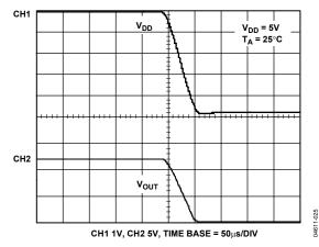
Figure 25. V<sub>DD</sub> vs. V<sub>OUT</sub>
