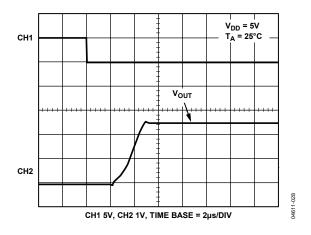
Figure 28. Exiting Power-Down Mode
