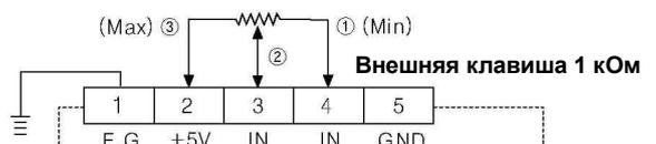
※ Возможно регулировать выходной сигнал при помощи функции Out ADJ, согласно описанной выше методике. Если функция Out ADJ не используется, установите при помощи клавиши значение 100% (См. на стр. D-5 более подробное описание функции Out ADJ).
