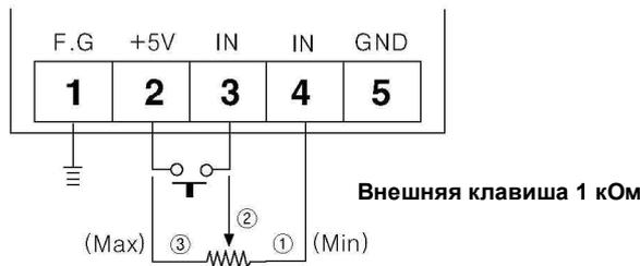
Пример 2) Показывает, как осуществить регулирование в диапазоне от 0 до 100% в режимах фазного и циклического регулирования без использования внешней клавиши. Это возможно при помощи клавиши OUT ADJ, при соединенных клеммах 2 и 3.
