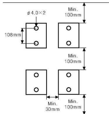
\*Приборы размещаются на некотором расстоянии друг от друга для обеспечения надлежащего охлаждения.
