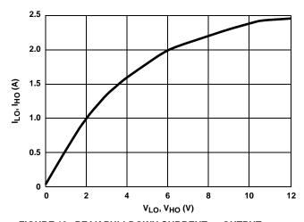
FIGURE 13. PEAK PULLDOWN CURRENT vs OUTPUT VOLTAGE
