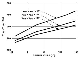
FIGURE 7. HIGH LEVEL OUTPUT VOLTAGE vs TEMPERATURE
