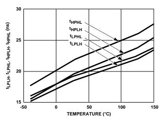
FIGURE 11. PROPAGATION DELAYS vs TEMPERATURE
