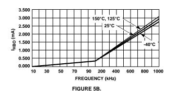
FIGURE 5. OPERATING CURRENT vs FREQUENCY
