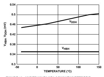
FIGURE 10. UNDERVOLTAGE LOCKOUT HYSTERESIS vs TEMPERATURE
